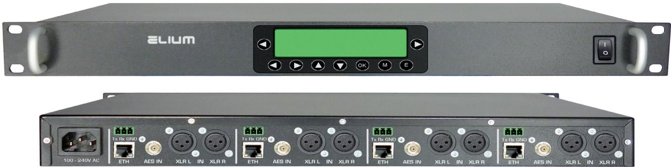
Der **AEN 4074** ist ein **professioneller bidirektionaler vierfach-Encoder**, der es ermöglicht bis zu **acht** Audioquellen (XLR-L/R oder AES) in vier IP-Streams zu encodieren. Die erzeugten MPEG 4 (H264) Streams werden über die Ethernet Schnittstellen dem IP-Netz bereit gestellt.
