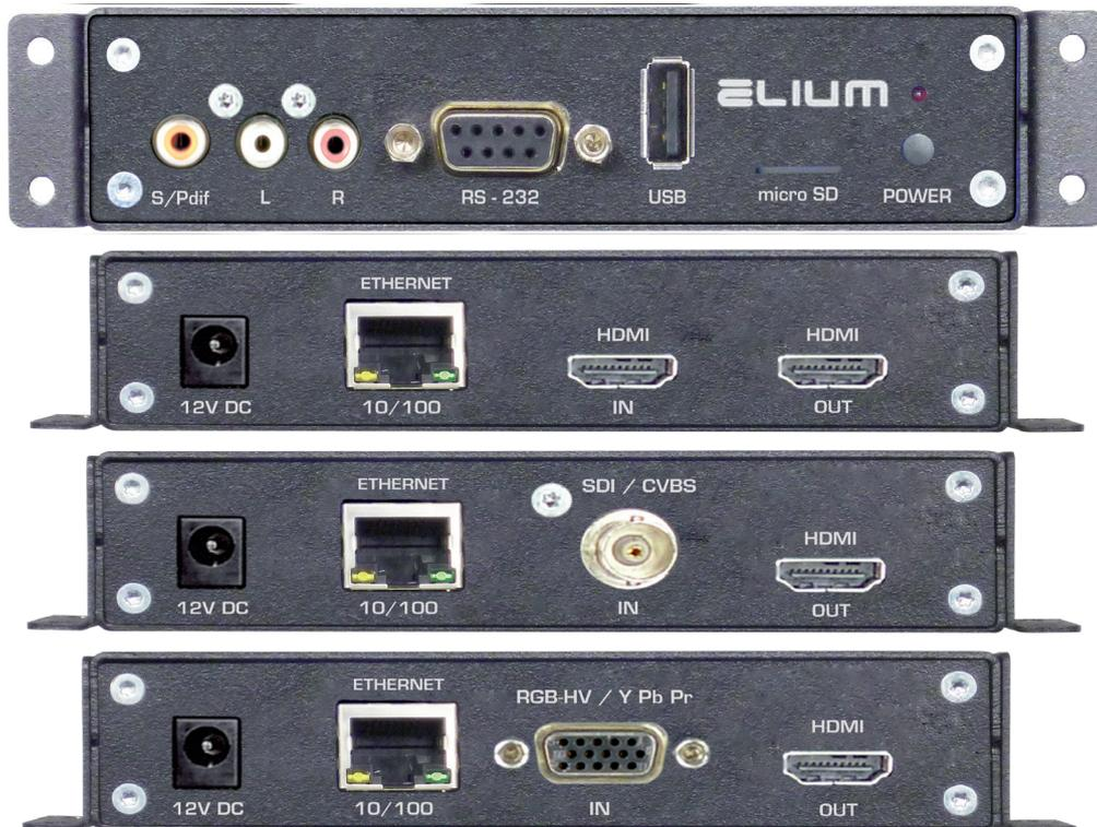
Der **EN 380 HD** ist ein **professioneller bidirektionaler Encoder**, der es ermöglicht eine Videoquelle (HDMI, SDI oder CVBS, RGB-HV / Y,Pb,Pr) und/oder Audioquelle (Audio-L/R, S/Pdif) in einen IP-Stream zu encodieren. Der erzeugte MPEG 4 (H264) Stream wird über die Ethernet Schnittstelle dem IP-Netz bereitgestellt.
