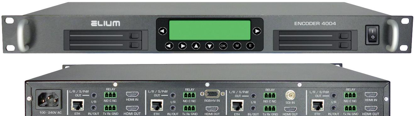
Der **VEN 4054 HD** ist ein **professioneller bidirektionaler vierfach-Encoder**, der es ermöglicht bis zu **vier** Videoquelle (HDMI, SDI oder CVBS, RGB-HV / Y,Pb,Pr) und/oder Audioquelle (Audio-L/R oder S/Pdif) in vier IP-Streams zu encodieren. Die erzeugten MPEG 4 (H264) Streams werden über die Ethernet Schnittstellen dem IP-Netz bereit gestellt.
